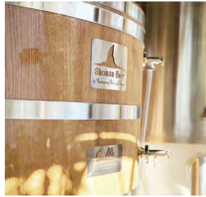
ウイスキー用の発酵槽であるフーダー
